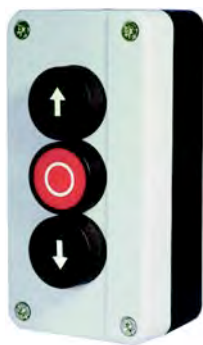
7 AUF/AB: je 1 Öffner + 1 Schließer, STOP: 1 Öffner Maße (H x B x T) 134 x 68 x 51 mm
