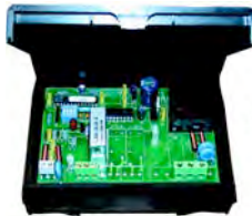
Maße (L x B x T): Decoder: 128 x 140 x 50mm Code-Tastatur: 75 x 75 x 12mm
