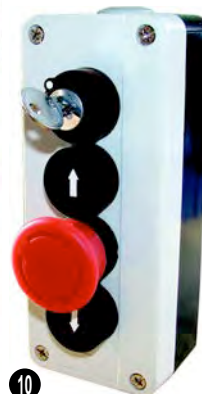
9 AUF/AB: je 1 Öffner + 1 Schließer Not-Halt/Stop: je 1 Öffner, Schloß mit 2 Schlüssel (AUS-EIN): 1 Schließer Maße (H x B x T): 164 x 68 x 51 mm
