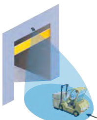
Ausblendung der Fussgänger, nur Fahrzeuge werden erfasst.
