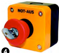
4 NOT-HALT: 1 Öffner mit Schloß + 2 Schlüssel Maße (H x B x T) 68 x 68 x 51 mm
