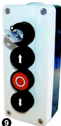
9 AUF/AB: je 1 Öffner + 1 Schließer Not-Halt/Stop: je 1 Öffner, Schloß mit 2 Schlüssel (AUS-EIN): 1 Schließer Maße (H x B x T): 164 x 68 x 51 mm
